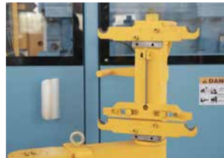
Unidade de troca rápida de ferramental (QPC)
