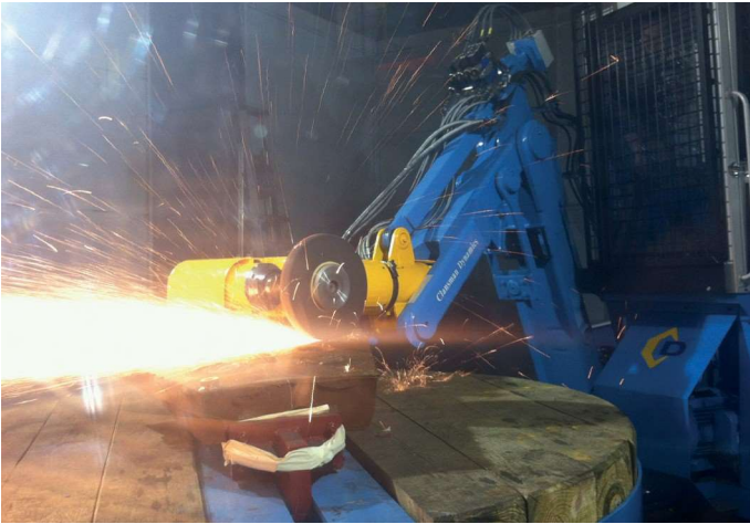
G30 rebarbador e mesa giratoria em construção para a rebarbação de quadros de locomotiva
