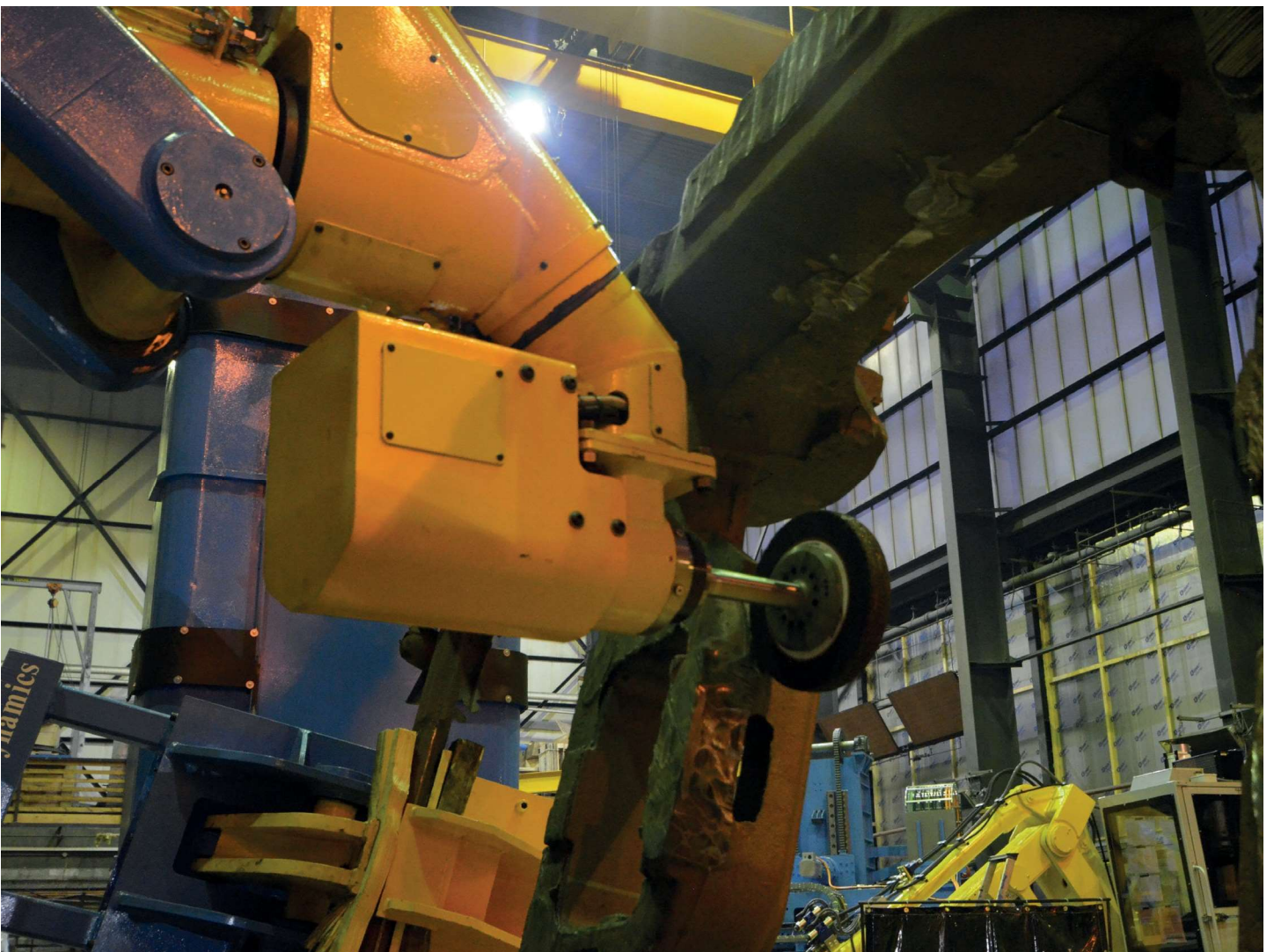
Rebarbador G30 tem um eixo hidráulico de 30 KW
