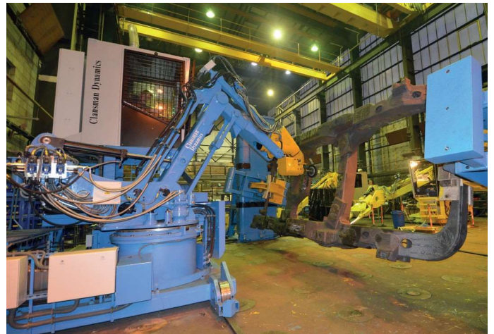
G30 rebarbador e mesa giratoria em construção para a rebarbação de quadros de locomotiva
