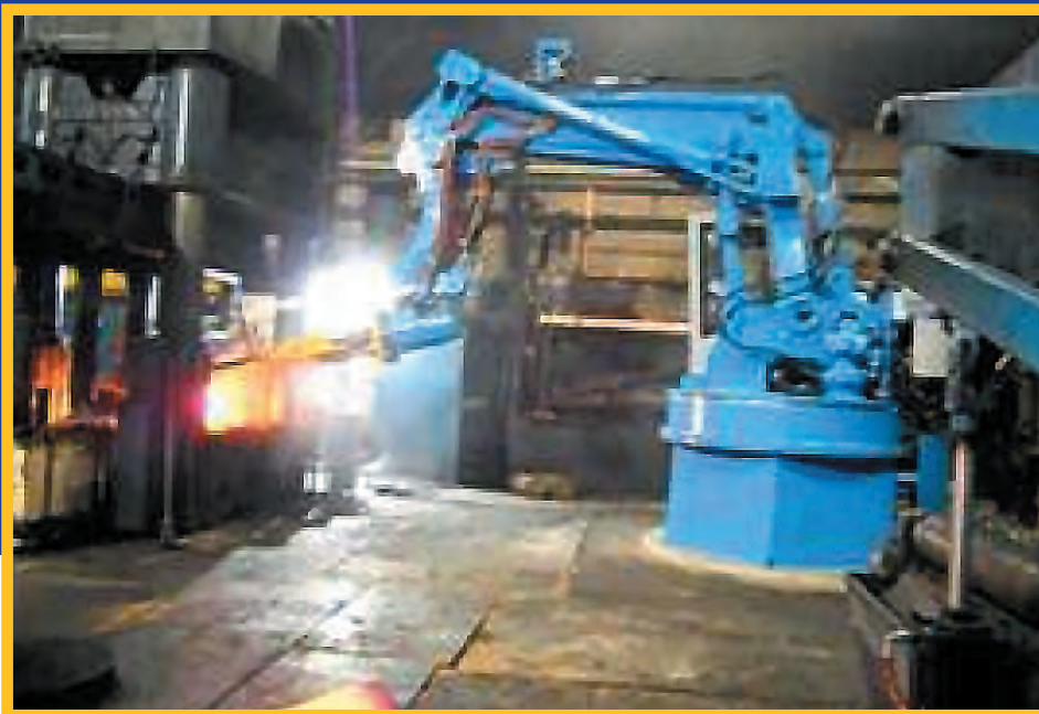
Checking furnace and press sight lines – Semi Auto (2 tonnes) Vérification de la capacité de l'opérateur de voir dans le four et sur la presse et de voir la pièce qu'il essaie de prendre Ofenprüfung und Pressen Sichtlinien - halbautomatisch (2 Tonnen) Asegurando una buena visión de la prensa y el horno Lavora in modo semiautomatico in linee con forno e pressa Проверка линий видимости печи и пресса – полуавтомат (2 тонны) 检测炉子和压机的视线-半自动 (2吨)
