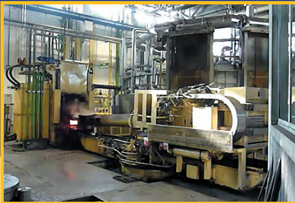
Furnace to descaler to closed die press – auto (2.5 tonnes) Du four au décalaminage près de la presse de matriçage-auto (2,5 tonnes) Vom Ofen zur Entzunderung zur Formpresse - automatisch (2,5 Tonnen) Horno a decapado a molde cerrado – auto ( 2,5Tn ) In automatico (2,5 Ton.) dal forno alla descagliatrice alla pressa a stampi chiusi. От печи к устройству удаления окалины и далее к прессу закрытой штамповки - авто (2,5 тонны) 炉子到除磷机, 除磷机到压机-自动模式 (2.5吨)
