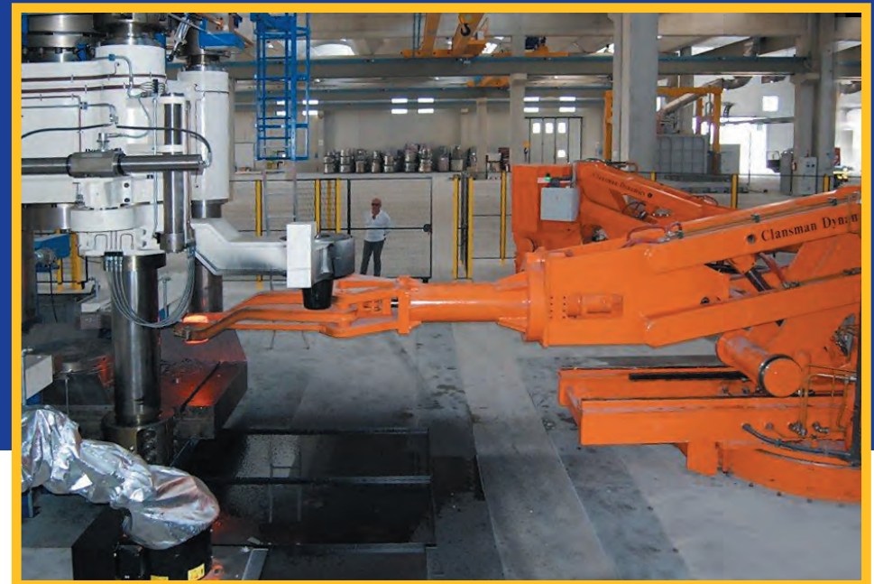
Furnace to closed die press –auto (1.5 tonnes) Du four à la presse de matriçage - auto (1,5 tonnes) Vom Ofen zur Formpresse - automatisch (1,5 Tonnen) Horno a molde cerrado – auto ( 1,5 Tn ) In automatico (1,5 Ton.) dal forno alla pressa a stampi chiusi От печи к прессу закрытой штамповки – авто (1,5 тонн) 炉子到模锻压机-自动模式 (1.5吨)
