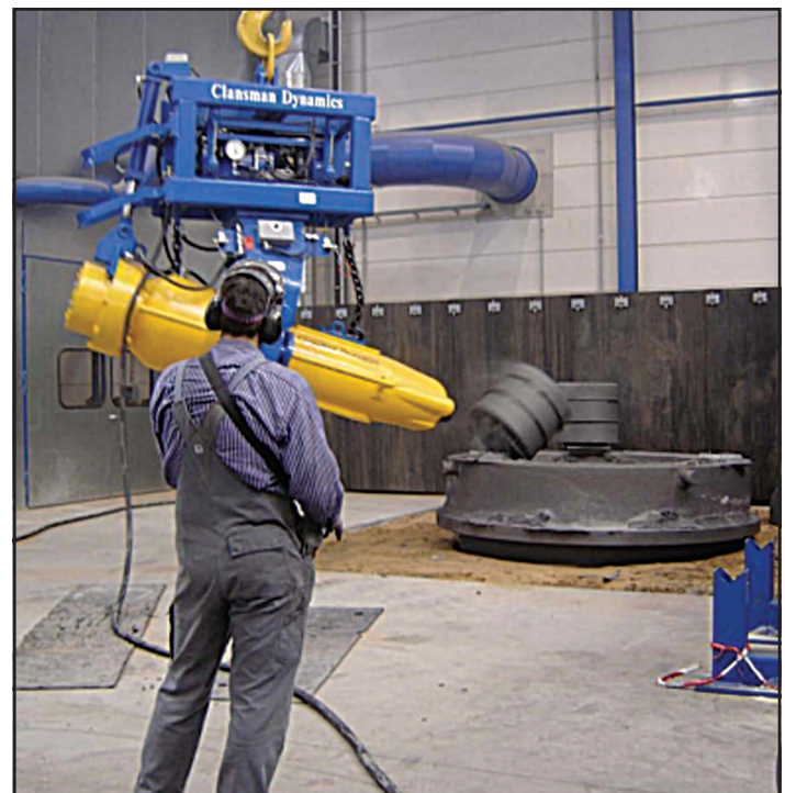
Lower pressure for smaller feeders. Niederdruckstufe für kleinere Speiserquerschnitte.
