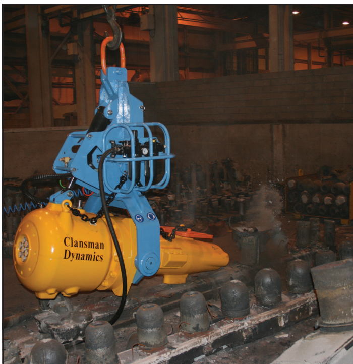
Hammer is crane mounted. Aufhängung Schusshammer in Kran.
